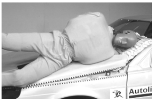
Ryc. 5. System PPA w czasie próby zderzeniowej z manekinem
